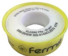
**Gewindedichtbänder aus ungesintertem PTFE. Chemische Beständigkeit gegen aggressivste Medien. Versprödet, quillt und klebt nicht. Enthält kein Öl und Fett. Verhindert das Festrosten (Leichtes Lösen nach Jahren selbst bei Stahlschrauben in Aluminium). Für Metall und Kunststoffgewinde geeignet.**
